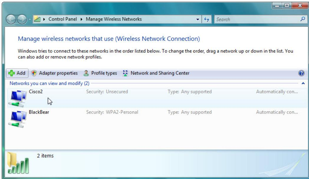
Lorsque la fenêtre « Gérer les réseaux sans fil utilisant (Connexion réseau sans fil) » (Manage wireless networks that use (Wireless Network Connection)) s'affiche, double-cliquez sur **Cisco#**, où # est le numéro qui vous est affecté.
